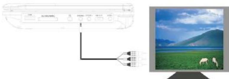
Примечание: AV кабель с желтым плагином используется для видео сигналов, кабели с красным и белым плагинами – для аудио сигналов.
